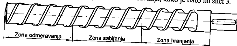
Slika 3. Karakteristične zone na ekstruzionom pužu
